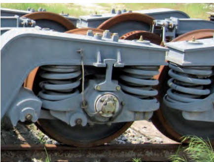
Fig. 2 - Molle in parallelo per carrelli ferroviari
