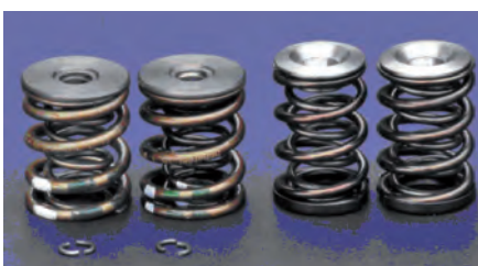
Fig. 1 - Esempio di molle in parallelo per valvole di motore a combustione interna
