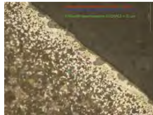
Foto 1 - Dettaglio decarburazione e difetti.
