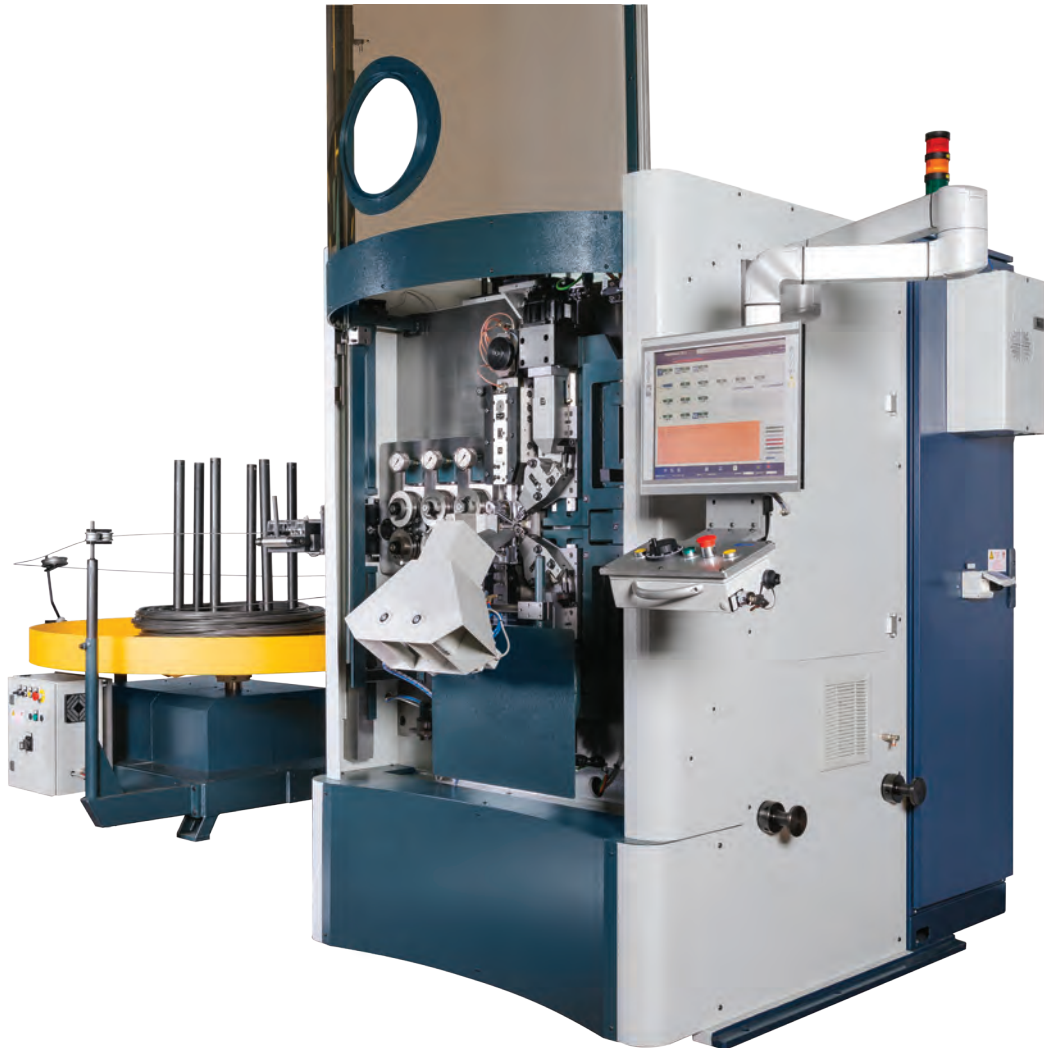
Macchine Avvolgitrici - Ø Filo: da 0,50 a 15,00mm - Spring Coiling Machines - Wire Ø: from 0,50 to 15,00mm
