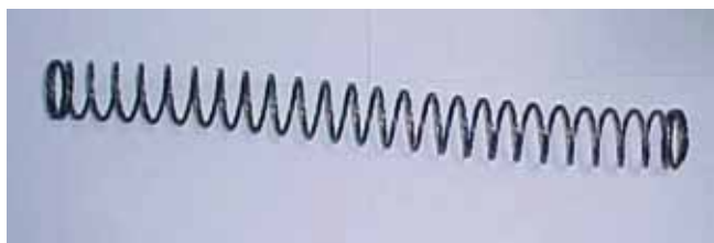
Fig.1: Molla a tre fili avvolti con D=27,25 mm; L=430 mm; N=27,2 ; d_0=1,4 mm; p=7 mm.
