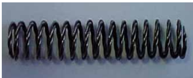
Fig.2: Molla a tre fili avvolti con D = 9,75 mm; L = 90 mm; N = 16,2 ; d_0 = 1 mm; p = 5 mm.
